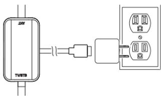
Conecte el amplificador con alimentación USB de la antena a un adaptador de alimentación USB (no incluido).
