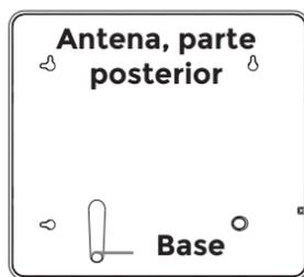
Esta antena ofrece dos opciones de instalación: la base provista o soporte de pared. Si quiere usar la base, insértela en una de las ranuras circulares ubicadas en la parte posterior de la antena. La antena puede instalarse de forma vertical u horizontal.
