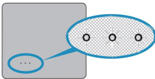
Mueva la antena hasta que el medidor de señal muestre al menos el segundo indicador. Para obtener el mejor rendimiento, intente que se muestre el tercer indicador.
