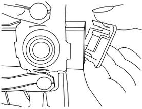
Inserte las tapas plásticas de los extremos en los extremos de los brazos según se muestra aquí. Utilice un martillo de goma para golpearlos suavemente de manera de introducirlos y asegurarlos en los brazos de la antena.
