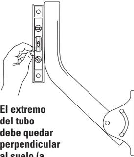
El extremo del tubo debe quedar perpendicular al suelo (a plomo)
