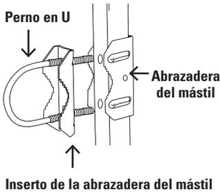
Encuentre el perno en U y el inserto de la abrazadera del mástil (vea la ilustración a la izquierda). Instale el perno en U en el inserto de la abrazadera del mástil de manera que los dientes del inserto de la abrazadera queden orientados hacia el lado cerrado del perno en U.
