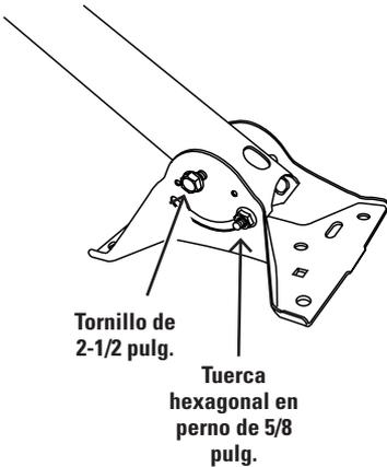
Encuentre el extremo del tubo de montaje con los orificios en los lados de los tornillos. Inserte este extremo en el centro del pie según se ilustra aquí. Luego inserte el tornillo de 2-1/2 pulg. a través del pie y del tubo según se ilustra. Atornille la tuerca hexagonal de 1/4 pulg. en el extremo del tornillo para sujetar el tubo y el pie entre sí. *No apriete la tuerca completamente todavía.*
