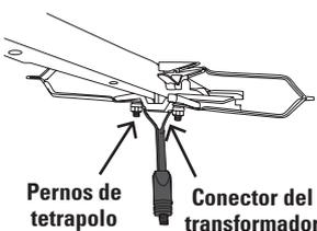
Utilícelas para fijar el transformador a la parte inferior de la antena y a los pernos del tetrapolo.
