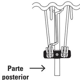
Comience por la parte posterior de la antena, desdoble los elementos de la parte superior e inferior de la antena hasta que queden fijos en su posición (según se ilustra a continuación). Cuando haya finalizado, asegúrese que los elementos queden planos y paralelos entre sí.
