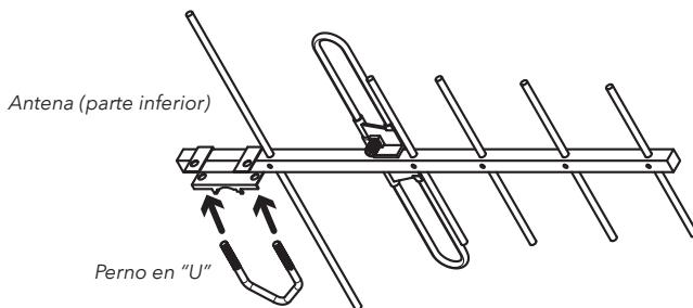
Atornille las dos tuercas mariposa al perno en "U" de forma tal que el soporte de montaje quede sujetado a la antena.
