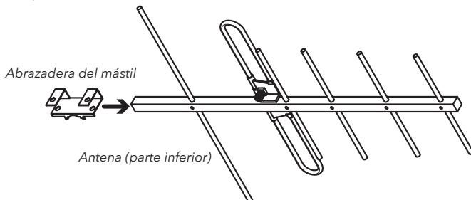
Coloque el perno en "U" a través de los orificios en ambos lados de la abrazadera del mástil.
